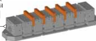
Çoklu bağlama şekli Figure multiple clamping
