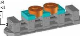
Yumuşak ayak ile bağlama şekli Figure clamping with soft legs
