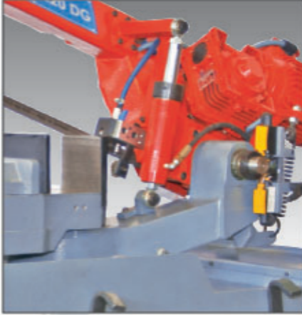
Hidrolik kesme iniş hızı kontrolü Speed control of hydraulic cutting downfeed
